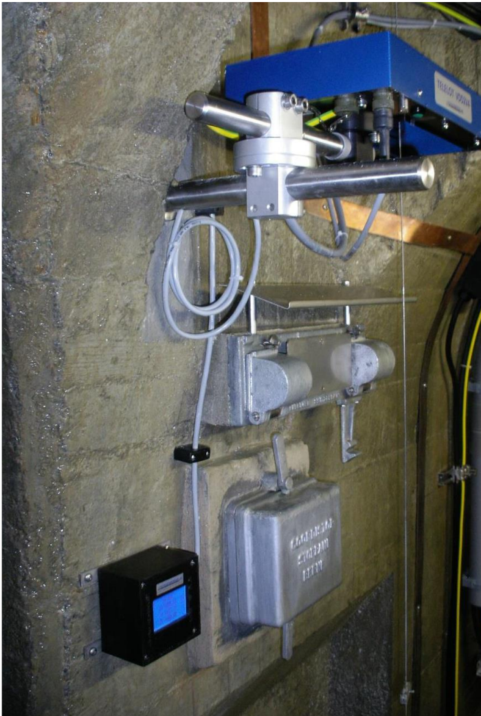
Bild 4 Beispiel aus einem anderen Projekt: An der Studie montiertes Telependelsystem Unterstützungssystem (unten links die Digitalanzeige der x-, y- und z-Drahtposition)
