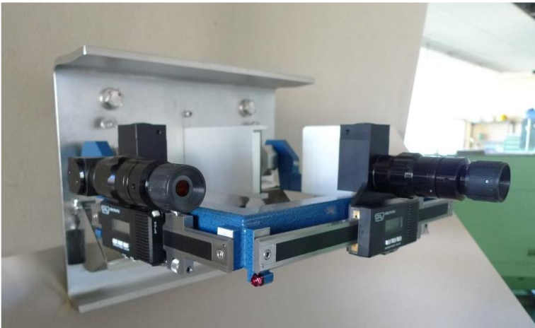
Bild 3 Beispiel: Optisches Koordiskop Typ KK84D
