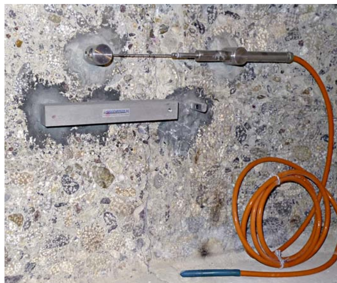
Typ TJM1DS für die 1-dimensionale Überwachung von Fugen und Rissen
