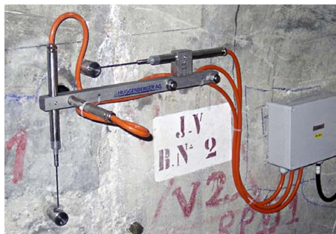
Typ TJM3DS für die 3-dimensionale Überwachung von Fugen und Rissen
